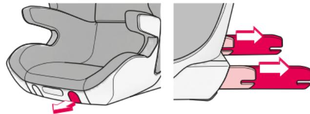
Poner el CONCORD TRANSFORMER en la dirección de la marcha sobre el asiento individual o el banco corrido del vehículo dotado de los enganches ISOFIX.
