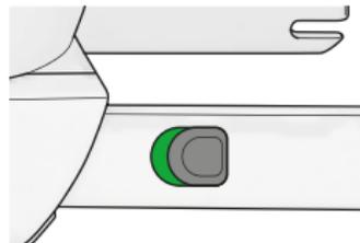
Mantenga apretado el botón TWINFIX (09) y lleve el CONCORD TRANSFORMER hacia atrás hasta que éste apoye lo más posible sobre el respaldo del asiento del vehículo. Soltar el botón TWINFIX (09) cuando la silla alcance la posición deseada.
