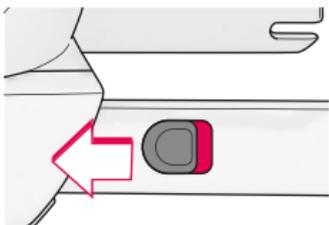
Para desmontar el CONCORD TRANSFORMER tirar hacia delante del botón TWINFIX (09) y mover la silla completa hacia delante. Tirar de los botones de seguridad del lado exterior del adaptador TWINFIX (10) hasta que queden en rojo los indicadores de seguridad. Tirar ahora de la silla hacia delante para sacarla de los enganches ISOFIX.
