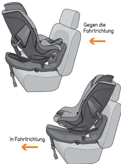
Ziehen Sie die Isofix-Halterungen (6) heraus, indem Sie den Knauf (9), seitlich am Grundgestell drehen. Der Stützfuß (12) klappt durch Schwerkraft auf. 1.a
