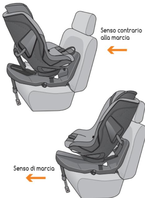
Estrarre gli ancoraggi ISOfix (6) girando il pomello (9) che si trova sul lato della base. La barra anti-rotazione (12) si apre per gravità. ①.a
