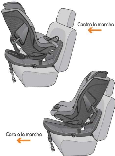
Extraiga los anclajes ISOfix (6) girando el pomo (9) situado en el lateral de la base. La pata anti-rotación (12) se despliega por gravedad. 1.a
