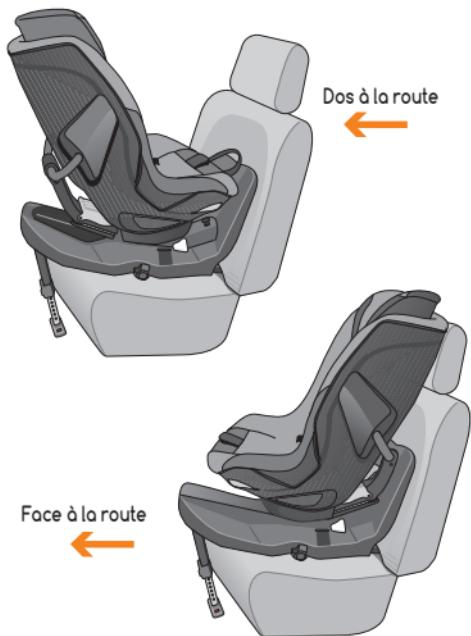
Retirez les fixations Isofix (6) en tournant la molette (9) située sur le côté du socle. Le pied anti-rotation (12) se dépliera de lui-même. ①.a
